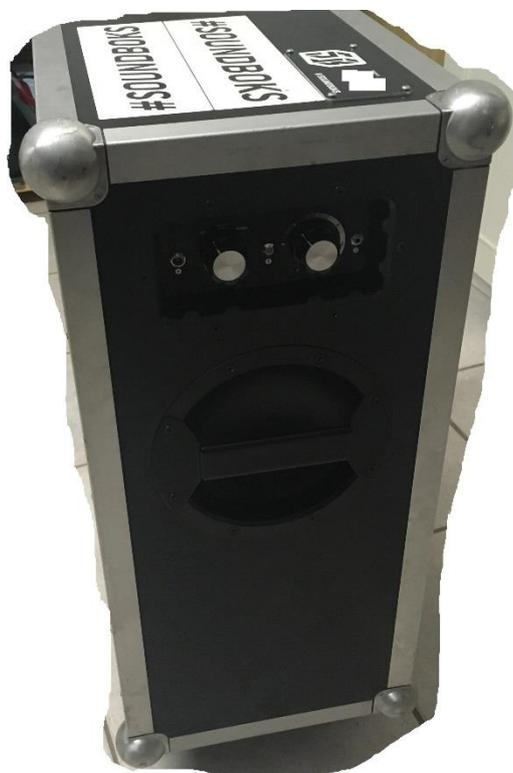
Seitenteil mit Bedienung. Zwei Knöpfe. Links EIN-Ausschalter/Normal-Modus/Bass-Modus, Rechts Lautstärkeregelung, Kontrollleuchte und Aux-in
